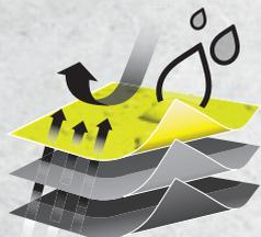
Das 3-lagige Warnschutz Softshell Gewebe besteht aus aussen 94% Polyester und 6% Elasthan auf TPU-Membran laminiert, innen mit 100% Polyester Micro Polar Fleece beschichtet. Das Außengewebe ist wasserfest und winddicht, während das Innengewebe Kälteschutz und gute Atmungsaktivität bietet.
